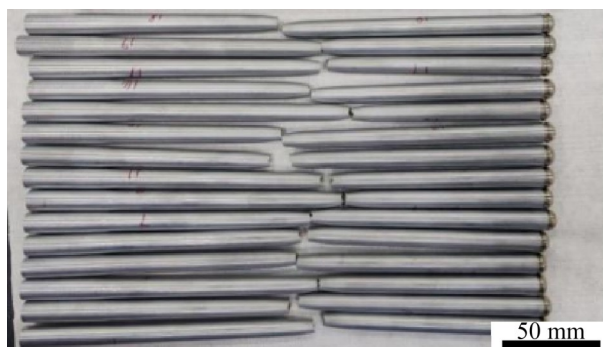
图 8 压力电阻焊试样拉伸结果
