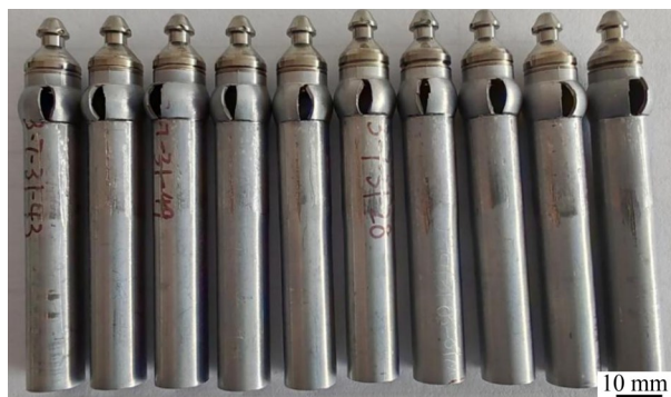
图 9 压力电阻焊试样爆破结果
